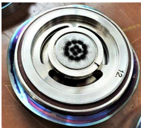
Obr. 14: Dvanácté patro impaktoru s depositem prachu na polykarbonátové fólii.
